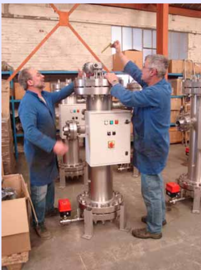
Montage de la boîte électrique
