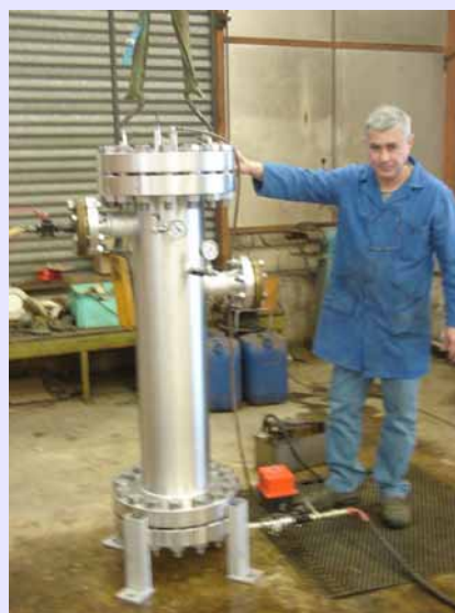
Vérification de la pression supportée par les soudures
